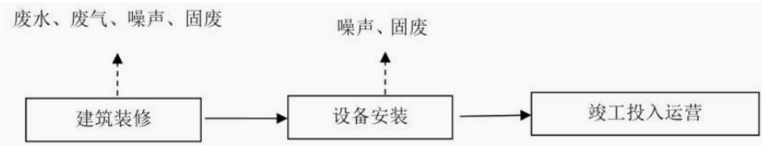
图 2-2 施工期工艺流程及产物节点图
